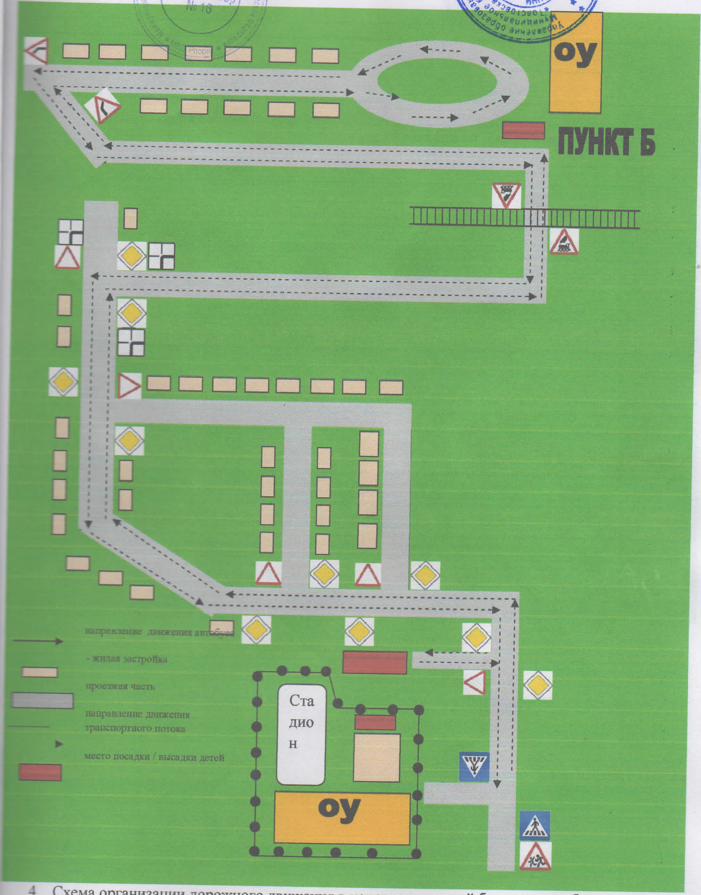
4. Схема организации дорожного движения в непосредственной близости от образовательного учреждения с размещением соответствующих технических средств, маршрута движения детей вблизи ОУ.
